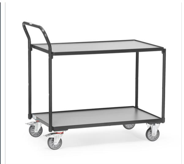
Tischwagen "GREY EDITION" aus Stahlrohr und Profilstahl geschweißt, pulverbeschichtet anthrazitgrau RAL 7016. Schraubkonstruktion. 2 Böden aus Holzwerkstoffplatte, Oberfläche mittelgrau im Stahlrahmen liegend mit Rand 12 mm hoch. Schiebegriff hochstehend. 2 Lenk- und 2 Bockrollen, TPE-Bereifung, Naben mit Rillenkugellager. Feststeller an den Lenkrollen, gemäß der Europäischen Norm EN 1757-3 (Sicherheit von Plattformwagen). Tragkraft obere Ladefläche 80 kg.
